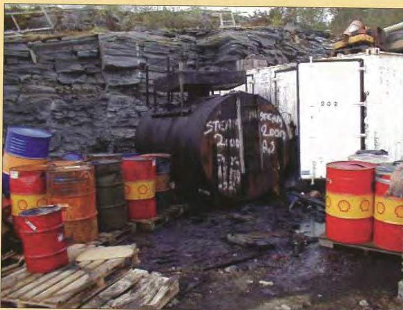
På bedriftsområdet til en gjenvinningsbedrift i Nord-Norge ble det lagret avfall innholdende bl.a. spillolje, fotokjemikalier, batterisyre, PCB holdige isoleringsglassruter og annet spesialavfall med den følge at det oppsto fare for forurensning.
